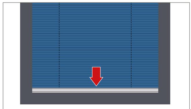
5. Drücken des Wippschalter (- oder =) bis der Plisseebegang die untere Position an der Fixschiene erreicht hat, der Plisseebegang ganz geschlossen ist. Falls der Motor nicht innerhalb 1 Sekunde stoppt, Wippschalter loslassen.
