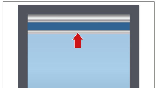
3. Drücken des Wippschalters (- oder =) und den Plisseebegang mit voller Geschwindigkeit wieder auf Paket fahren (bis er oben anstößt) bis der Motor stoppt, dann Wippschalter loslassen.
