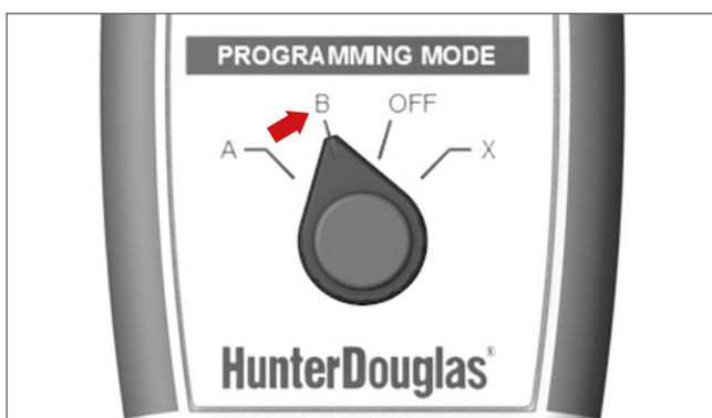
4. ACHTUNG nur bei AE und BE Plissees - Drehknopf auf Position B stellen, dann drücken des Wippschalter (- oder =) und den Plisseebegang zufahren lassen bis zu Endposition, dann Wippschalter loslassen.
