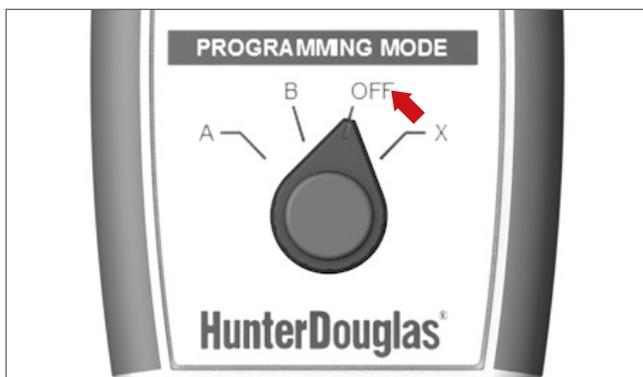
Drehknopf auf OFF Position, Programmierung ist abgeschlossen.
